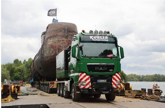
Nachdem U17 auf dem 30-Achsen SCHEUERLE InterCombi Plattformwagen vor dem Flussponton der Firma Van der Wees positioniert wurde, schob sich der Tieflader samt U-Boot Meter für Meter auf den Ponton. Quelle TMSNHSP
