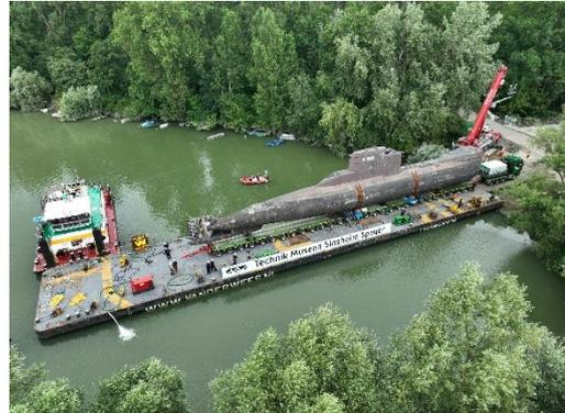
Immer wieder stoppte der Tieflader, um die Ballastierung des Pontons anzupassen, sodass dieser trotz veränderter Last gerade und stabil im Wasser liegt und die 500 Tonnen (150 Tonnen Tieflader und 350 Tonnen U-Boot) Stück für Stück auffahren konnten. Quelle TMSNHSP
